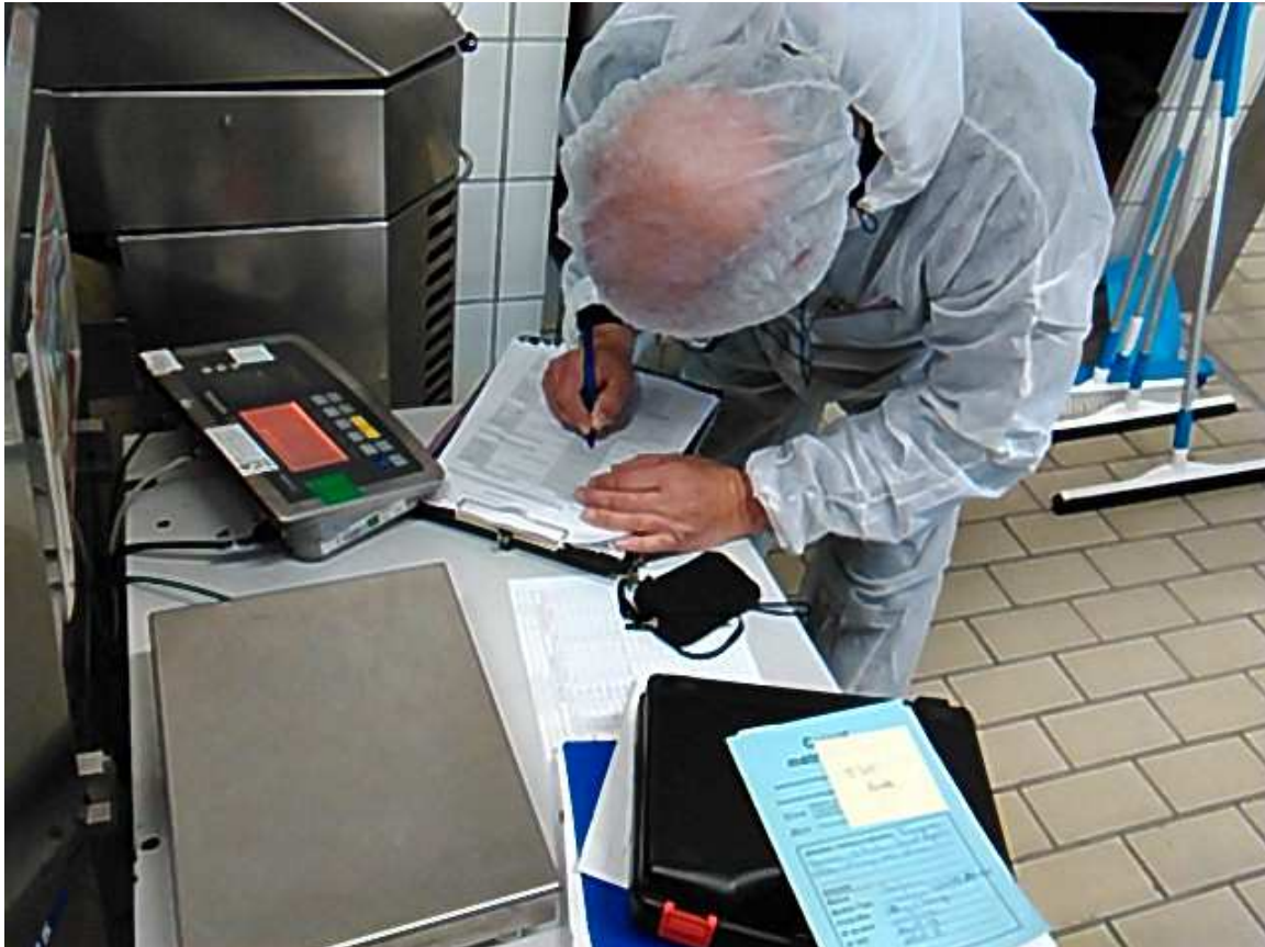
Un agent lors d'un contrôle d'un instrument de pesage dans le secteur agro-alimentaire
